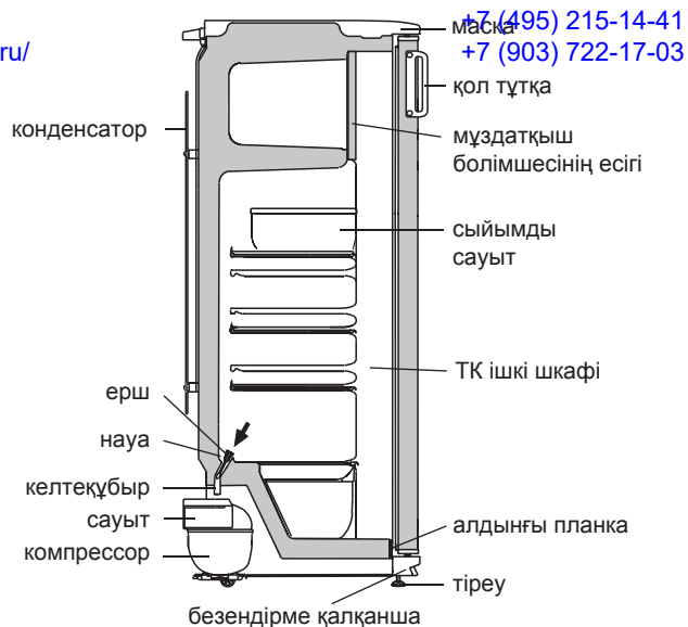
4 сурет — Еріген суды ТК-нан ағызу схемасы
