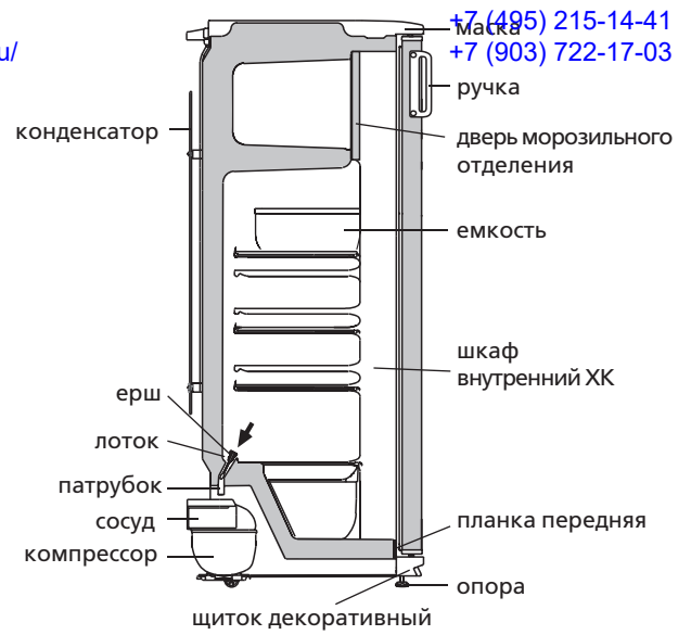
Рисунок 4 — Схема слива талой воды из ХК
